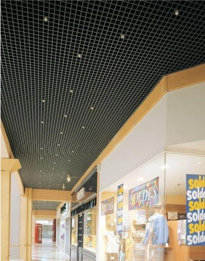
**Грильято** и потолки с панелями из просечно-вытяжной сетки сохраняют объём воздуха для циркуляции. Эти варианты используют, когда надо придать структурности потолку, где светоотражение от потолочной поверхности не имеет значения.
