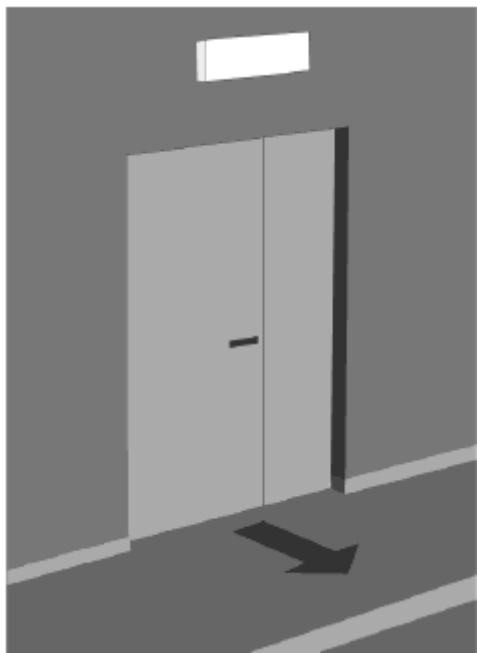
Рисунок 5.9 - Расположение светильника эвакуационного освещения снаружи здания
